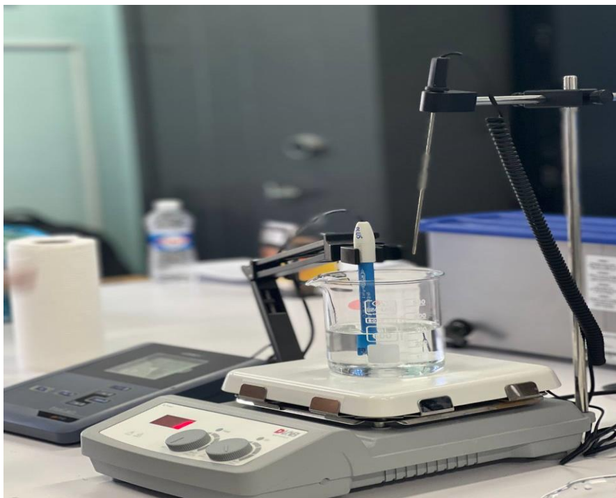
Figure 34: Ajustement du pH du tampon phosphate par le pH-mètre
